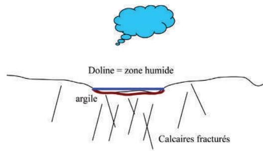
laissent en surface des argiles résiduelles non solubles, dites de décarbonatation, donc neutres chimiquement, qui tapissent les dolines. Les contours de ces zones sont très clairement délimités par le tapissage d'argile. L'alimentation se fait uniquement par les eaux de pluie sur un bassin versant très limité correspondant à la zone humide elle-même.
