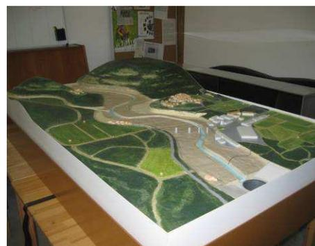
Cette maquette interactive permet de visualiser les phénomènes de ruissellement urbain (cuvette en zone urbanisée,...), les ruptures de digues avec inondation d'un quartier, ainsi que différents impacts (sur-inondation d'une route, d'un quartier,...) sur l'aval des cours d'eau suite à des aménagements (construction d'un lotissement en lit majeur, réduction du champ d'expansion de crue par remblais,...) en débit constant (en niveau lit mineur ou lit majeur).
