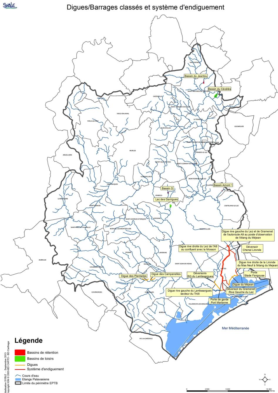
Figure 93 : Digues/barrages classés et système d'endiguement
