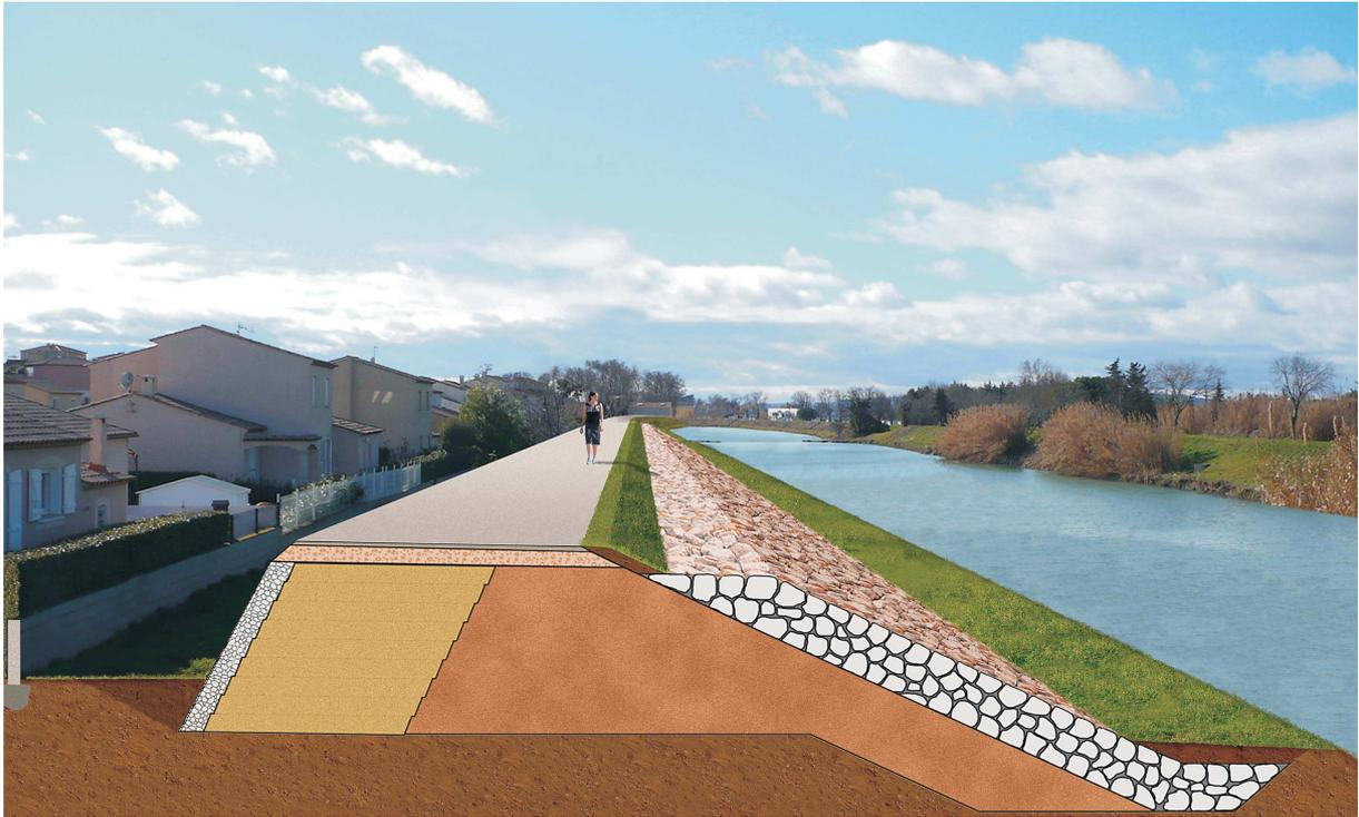
*Figure 115 : Principe du confortement avec dispositifs de soutènement au droit des zones à emprise limitée.*
