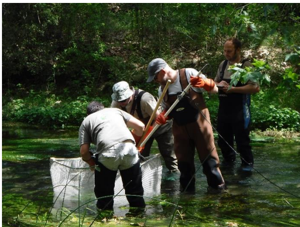
Figure 10: Illustration de l'échantillonnage piscicole avec le cadre à projection prospecté par pêche à l'électricité.
